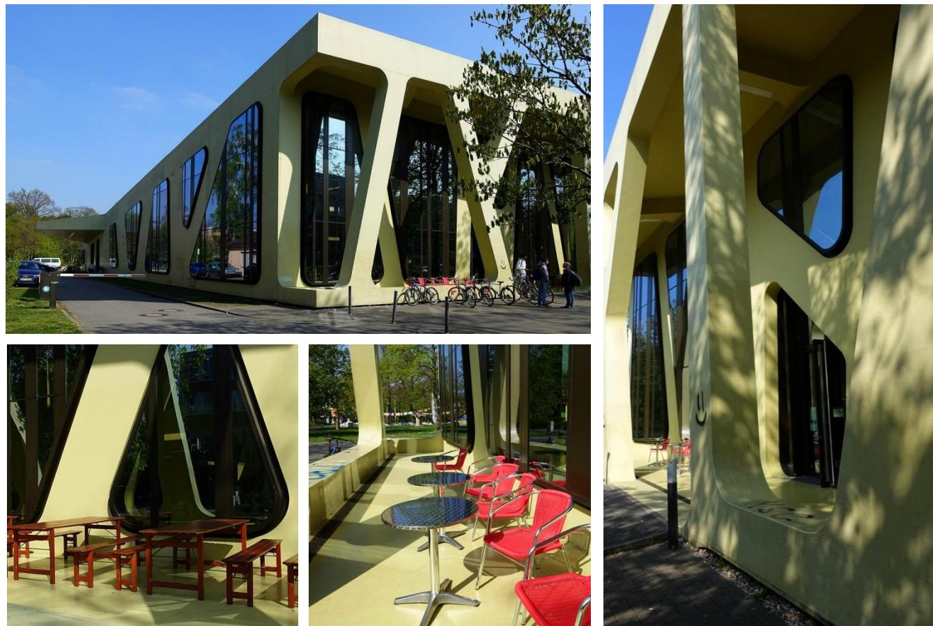
Bei den Materialien ging man ganz neue Wege. Das äußere Tragwerk ist nicht Stahl oder Beton, es sind Kastenprofile aus weniger als 10 Zentimeter starkem Schichtholz, gefüllt mit einer Kerndämmung. Umhüllt wird das Holz mit einer heiß aufgespritzten, diffusionsoffenen Polyurethan-Kunststoffbeschichtung, die UV-fest lackiert ist. Die Fassadenkonstruktion setzt sich auch im pultförmig geneigten Holzdach fort. Das Dach ist fugenlos glatt und zum Teil als Dachterrasse nutzbar.
